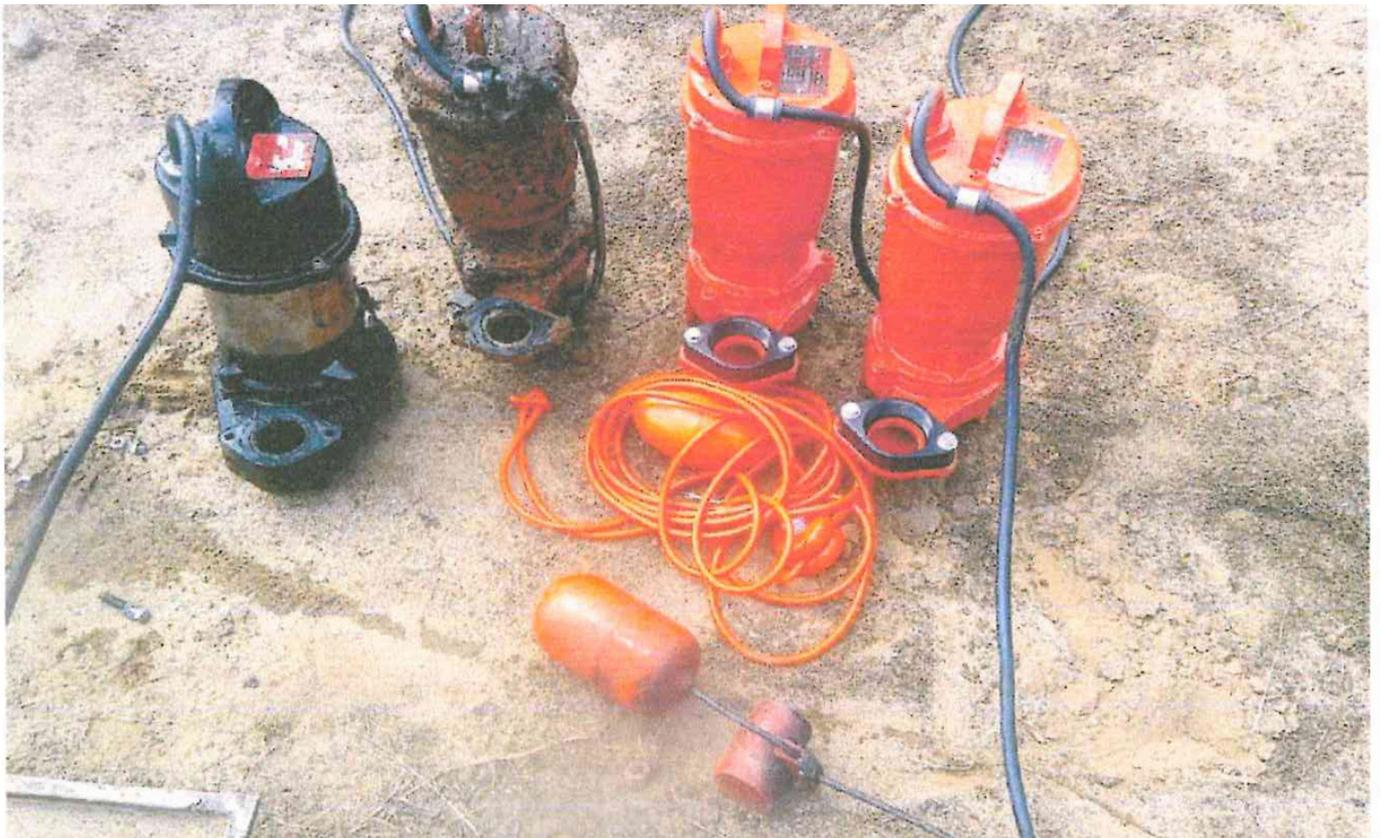
保守業者の点検「合併処理施設運転日報」の中で調整ポンプの故障が発覚しました。原水槽からの水の流れが止まり、汚水が溢れる可能性があるため、ポンプ交換を行っていただきました。
