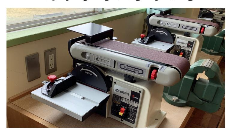
サンディングベルトを一定方向に高速回転させることで木材・金属などを効率的に研磨できる工具です。
